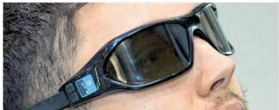
Koordinatives Zusammenspiel: Alexander Glöckle trägt eine sogenannte Strobe-Brille, die ihre Gläser abwechselnd erhellt und verdunkelt, und spielt die Bälle zu seinem Geschäfts- und Trainingspartner Simon Jans zurück. Der 25-Jährige hat wiederum ein Auge verdeckt. Fotos: Lars Schwerdtfeger
